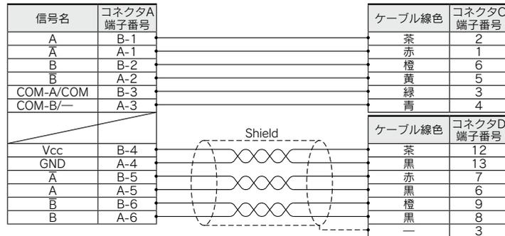
[インクリメンタル(ステップモータ DC24V)用ロック・センサ付ロボットケーブル、標準ケーブル]
