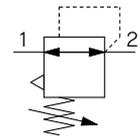
・逆流機能付は、出口側の空気圧を入口側へ排出させる機構を内蔵。
