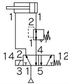
例2. エアの供給を停止し、レギュレータの入口圧力を大気開放する場合、確実にレギュレータの出口側エアの残圧排気ができます。
