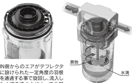
IN側からのエアがデフレクタに設けられた一定角度の羽根を通過する事で旋回し、流入した水滴を遠心力によって分離させます。
